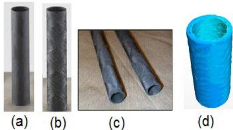
Figura 4. Tubos de revestimentos de carbeto de silício (a) monolítico, (b) duplex (CANES), (c) tríplex (Hallstadius et al. 2012) e (d) multicamadas (CANES).
