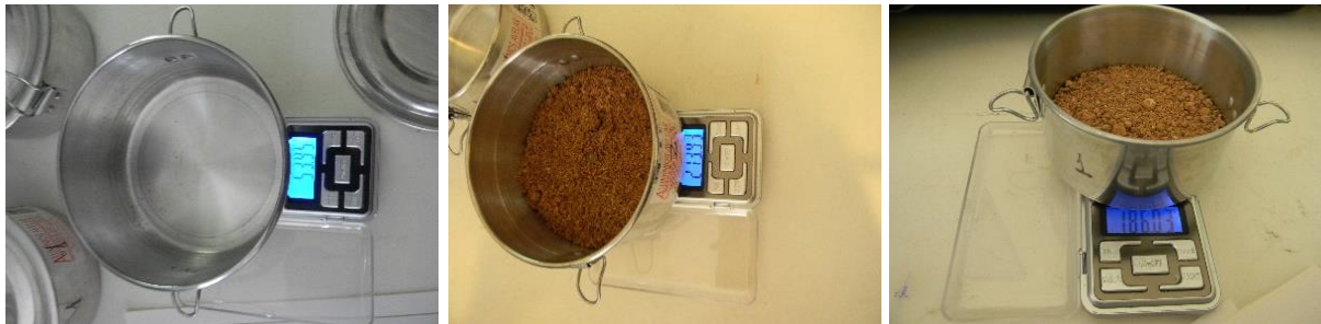
Figuras 92, 93 e 94: Pesagem das cápsulas sem a amostra, com amostra úmida e com amostra seca
