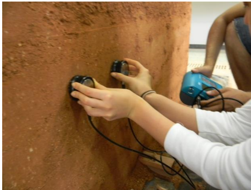
Figura 14: Ensaio de ultrassom no painel 5.
