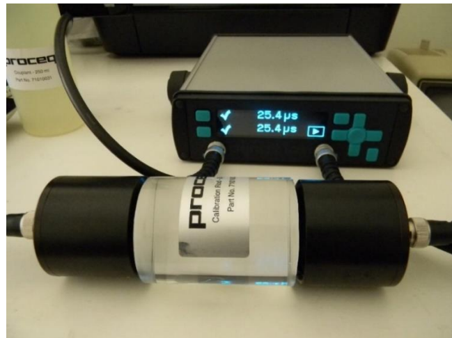
Figura 103: Calibração dos transdutores de 54 kHz.
