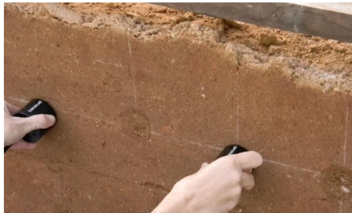
Figura 105: Ensaio de ultrassom com transdutores de 54 kHz
