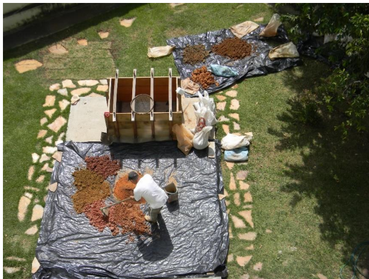
Figura 15: Processo de mistura do solo coletado e cedido pela Engesolo
