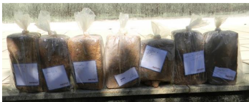
Figura 112: Amostras retiradas para ensaio à compressão simples
