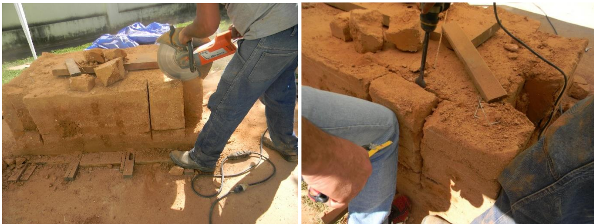
Figuras 110 e 111: Retirada de amostra com uso da serra e da britadeira
