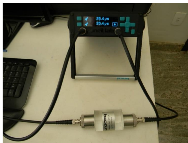
Figura 104: Calibração dos transdutores de 82 kHz
