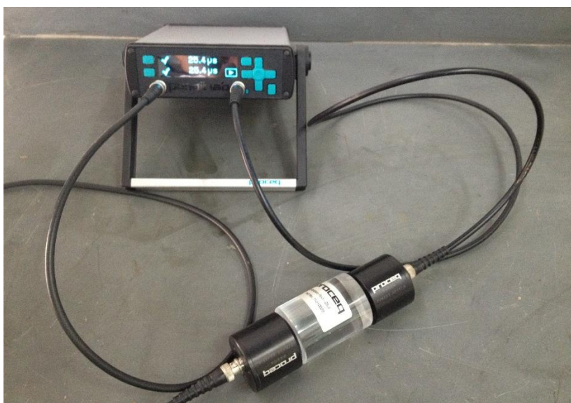
Figura 118: Calibração do ultrassom
