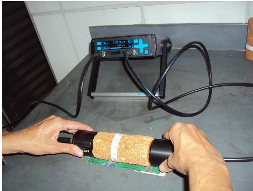
Figura 119: Ensaio de ultrassom nos corpos de prova
