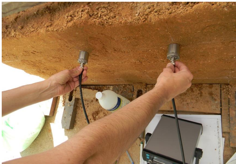
Figura 106: Ensaio de ultrassom com transdutores de 82kHz
