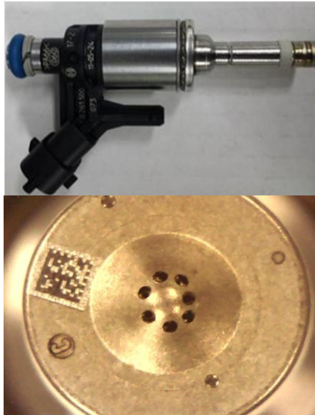
Figura 4.16 – Injetor de injeção direta Bosch se sete orifícios (modelo 0261500073) utilizado no motor de acesso óptico.
