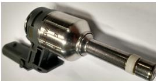
Figura 4.8 – Injetor de Injeção direta de um único orifício do tipo pressure-swirl utilizado nos testes estáticos.
