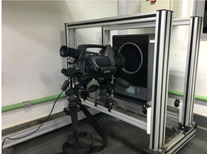
Figura 15 – Estrutura para verificação da conformidade do Termovisor Flir SC660.
