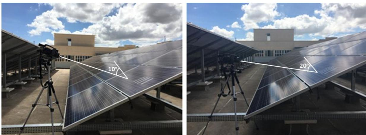
Figura 17 – Disposição das câmeras em relação aos painéis fotovoltaicos para análise de emissividade.
