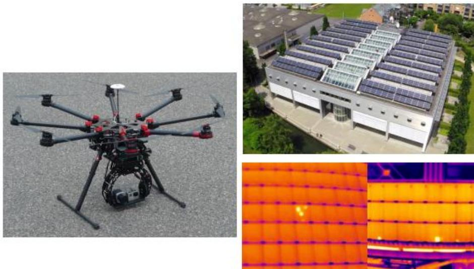
Figura 7 – Drones na termografia (MUNTWYLER, SCHÜPBACH e LANZ, 2015).
