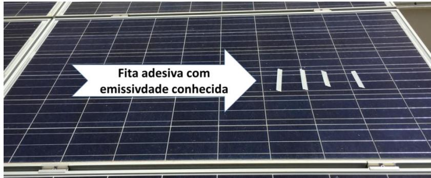
Figura 16 – Teste da fita para determinação da emissividade das células fotovoltaicas.
