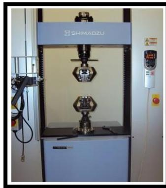
**Figura 16-Máquina Universal de ensaios da Shimadzu, modelo AG-X Plus.**
