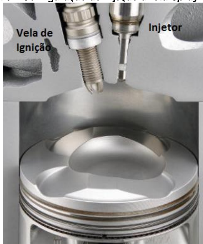
Figura 6 – Configuração de injeção direta Spray-Guided .
