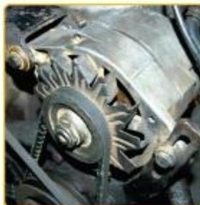
Com o carro em funcionamento, o **alternador** gera energia para o funcionamento do veículo e ainda carrega a bateria, que acumula energia para quando o motor não estiver funcionando.
