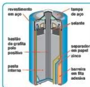
A pilha seca tem como vantagem o baixo custo e a não utilização de material tóxico. As desvantagens são o fato de não ser reciclada, a vida útil curta e o risco de vazamento.
