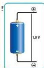
A diferença de potencial entre os polos de uma pilha normal é de 1,5 V. Os valores negativos indicam os potenciais elétricos em relação à Terra.
