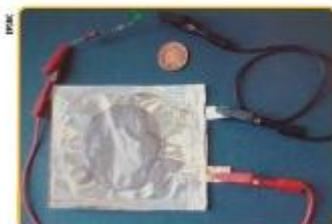
Com a demanda por baterias mais leves e mais resistentes, vem aumentando o interesse por baterias a ar. Nesse dispositivo, o óxido de lítio-cobalto é substituído por um eletrodo poroso de carbono. Essas baterias geram uma carga oito vezes maior que as baterias recarregáveis de lítio, por estar protegidas por dispositivo para não reagir com a água.
