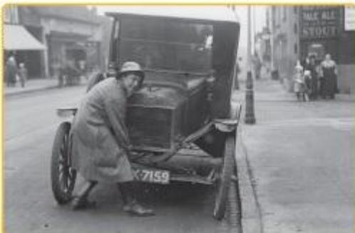
O desenvolvimento das **baterias de chumbo-ácido** dispensaram a necessidade de se dar a partida dos motores dos automóveis utilizando a força humana.
