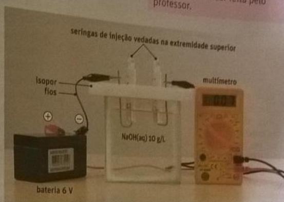
Esquema de montagem de experimento para determinação da constante de Avogadro.
