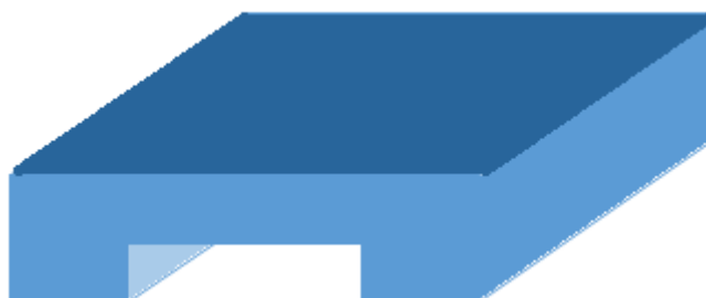
Figura 21: Ilustração da geometria do canal de macrofluídica em PDMS.
