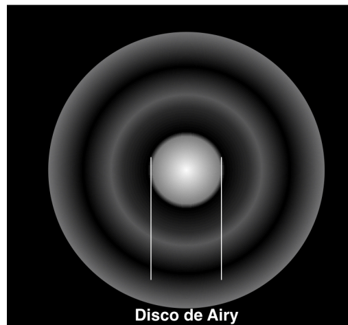
FIGURA 17 - PADRÃO DE IRRADIÂNCIA DA IMAGEM DE UM PONTO. O DISCO DE AIRY É A REGIÃO CENTRAL MAIS BRILHANTE.
