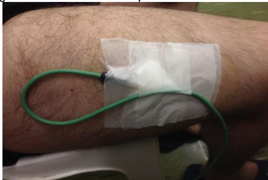
FIGURA 1 – Imagem ilustrativa do procedimento de fixação do sensor de temperatura muscular, garantindo assim o seu posicionamento correto.
