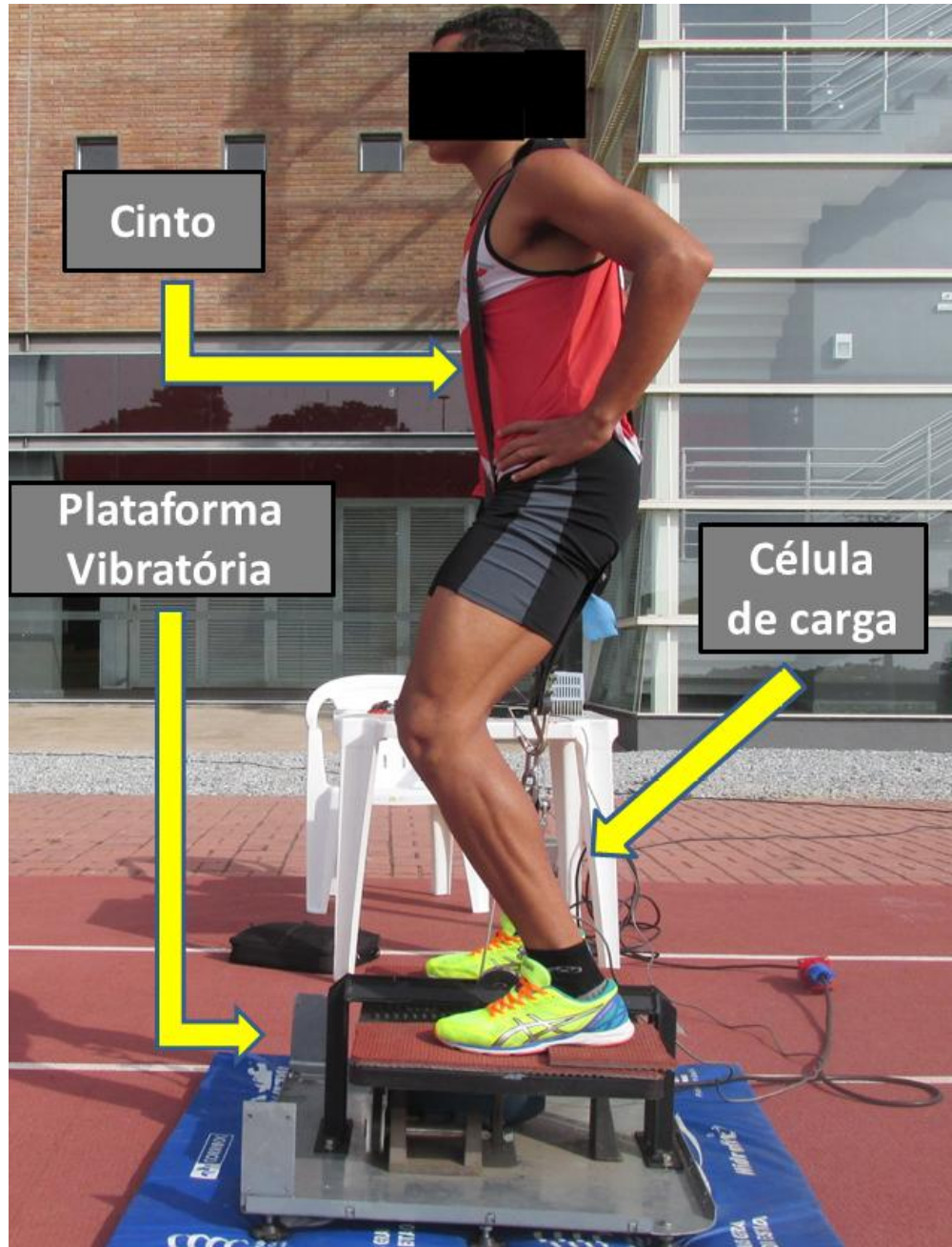
Figura 14. Equipamentos para a realização da CVIM com adição de vibração mecânica
