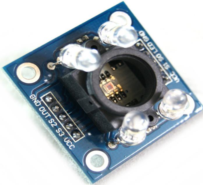
Figura 18: Sensor de cores RGB.
