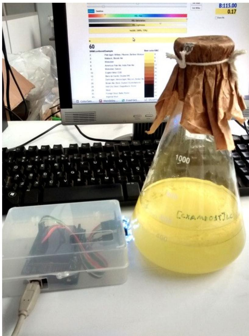
Figura 21: Exemplo de identificação da cor final da cerveja. A amostra é colocada em frente ao sensor e o sistema compara a cor medida com a tabela de cores padronizadas.
