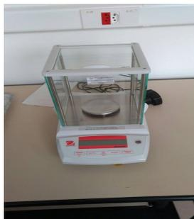
Figura 9- Balança analítica marca OHAUS Pioneer
