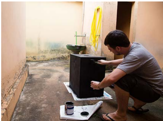
Figura 140: Pintamos de preto para refletir o mínimo a luz.
