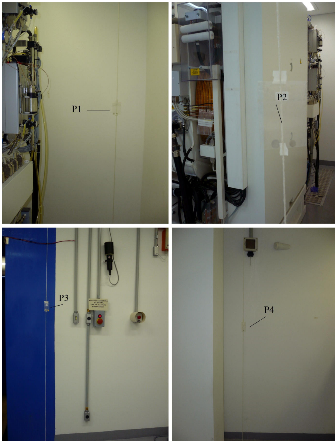
Figura 19. Arranjo experimental da irradiação das folhas de ativação nos pontos P1, P2, P3 e P4 na casamata do ciclotron PETtrace-8 do CDTN
