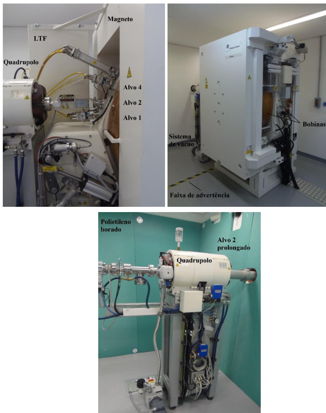
Figura 6. Cíclotron PETtrace-8 detalhando os seus alvos (acima), o alvo 2 prolongado (abaixo) e suas principais partes.
