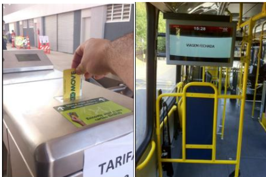
Figura 0.5: Sistema de cobrança e informação ao usuário no sistema BRT de Belo Horizonte (BHTRANS, 2017a).
