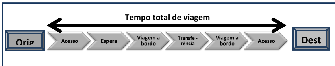
Figura 2.1: Componentes do tempo total de viagem em um sistema de transporte público.
