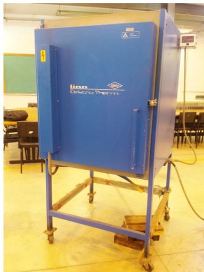
FIGURA 4.5: Forno empregado no recozimento.
