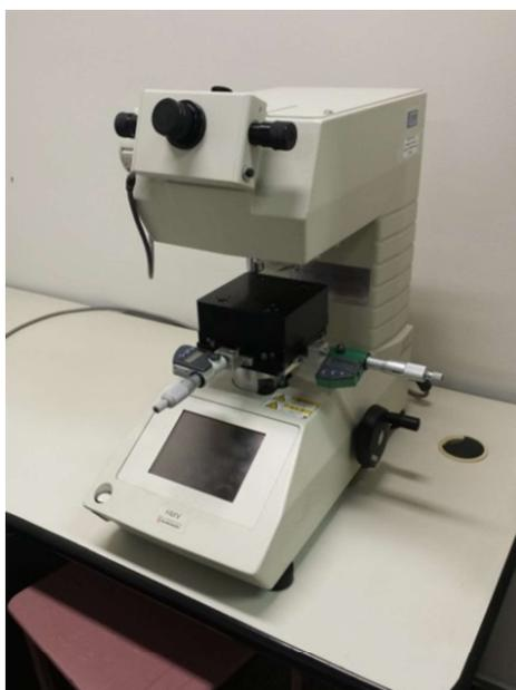
FIGURA 4.7: Microdurômetro Vickers.
