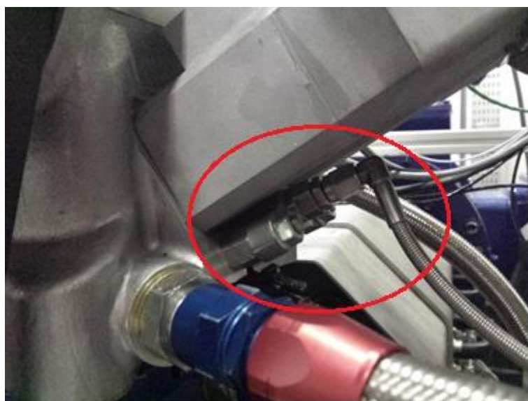
Figura A.5 – Injetor para injeção direta BOSCH HDEV_5.1 - Cortesia Centro de Tecnologia da Mobilidade
