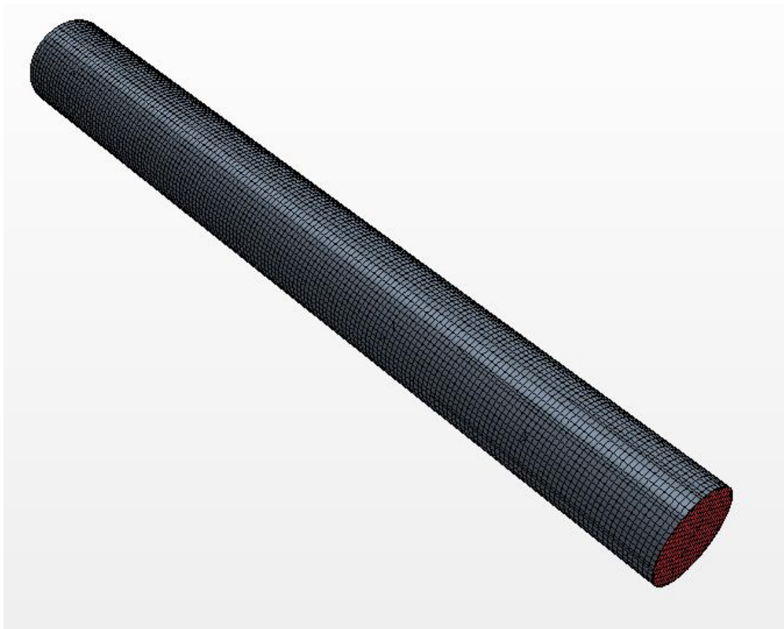
Figura 3.12 – Malha do duto de exaustão gerada no STAR-CCM+
