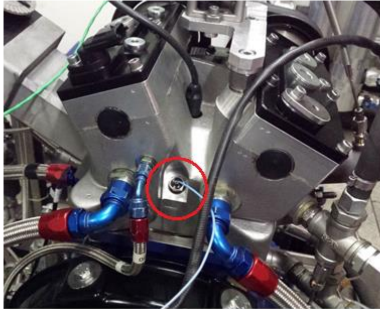
Figura A.6 – Sensor de Pressão no cilindro AVL GU22C - Cortesia Centro de Tecnologia da Mobilidade
