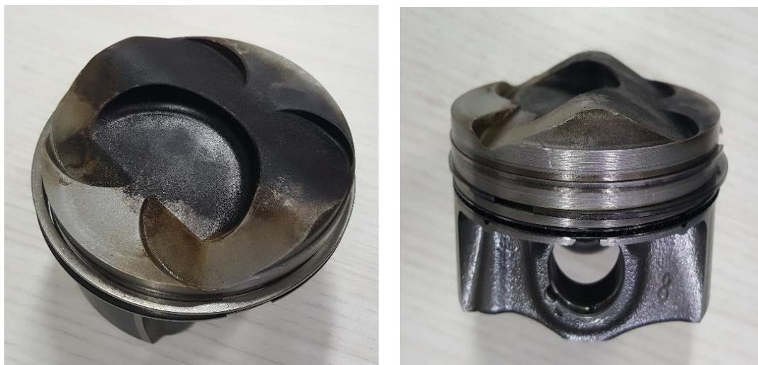
Figura A.1 – Pistão projetado pelo Centro de Tecnologia da Mobilidade para alcançar razões volumétricas de compressão entre 11,5:1 e 15:1 - Cortesia Centro de Tecnologia da Mobilidade
