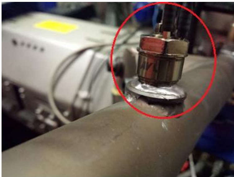
Figura A.12 – Sensor de pressão da exaustão AVL GU21D - Cortesia Centro de Tecnologia da Mobilidade
