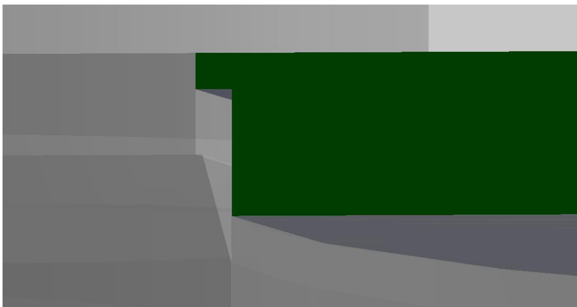
Figura 3.7 – Detalhe de simplificação do cilindro no volume interno do motor, o volume interno está em verde sobreposto a geometria do motor semitransparente
