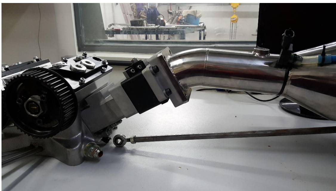
Figura A.3 – Montagem do sistema de admissão - Cortesia Centro de Tecnologia da Mobilidade
