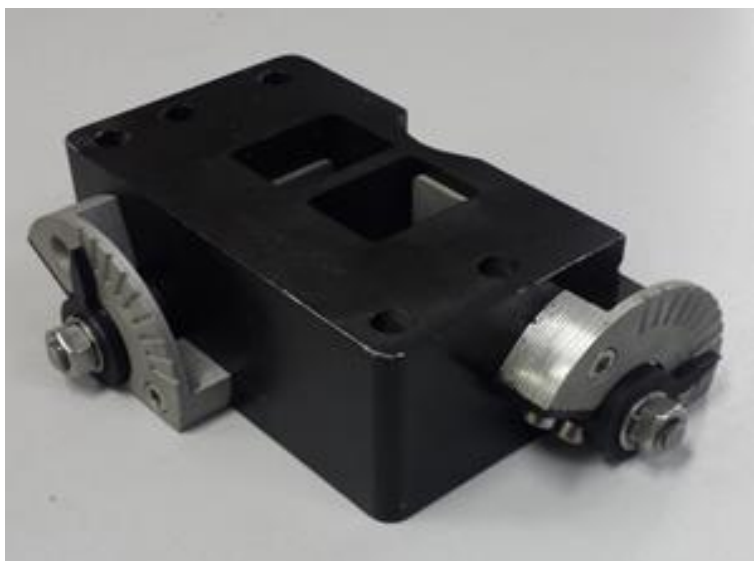
Figura A.2 – Flowbox projetado pelo Centro de Tecnologia da Mobilidade para variar estrutura de fluxo dentro do motor - Cortesia Centro de Tecnologia da Mobilidade
