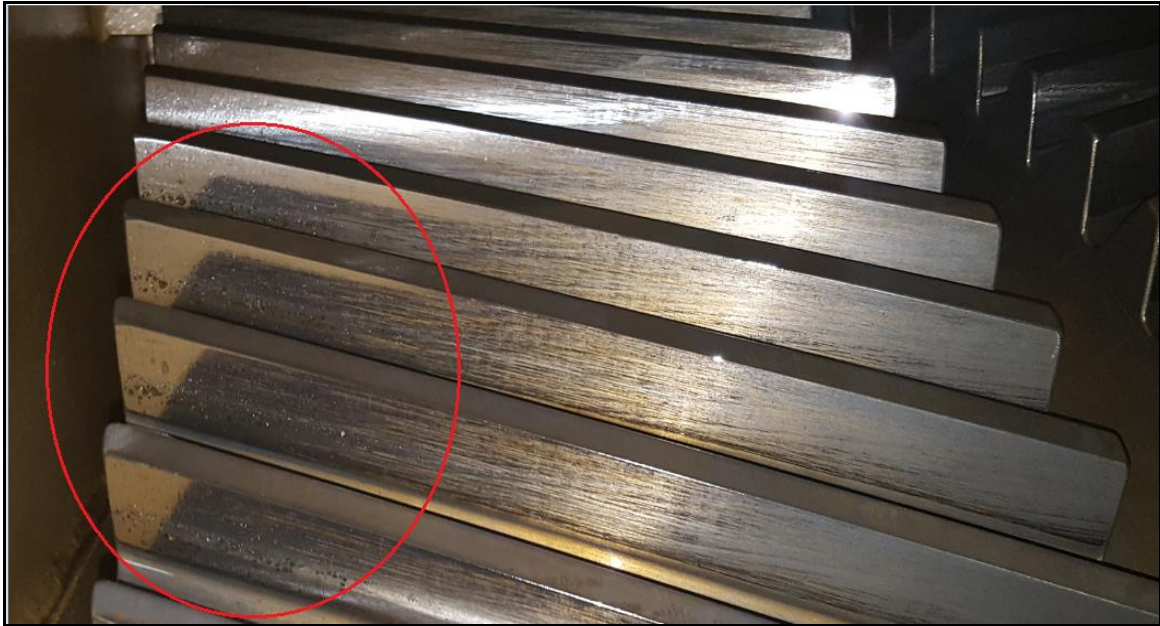
FIGURA 5.14- Foto da coroa da bobinadeira esquerda , evidenciando um pitting inicial na hélice esquerda (27/10/2016).
