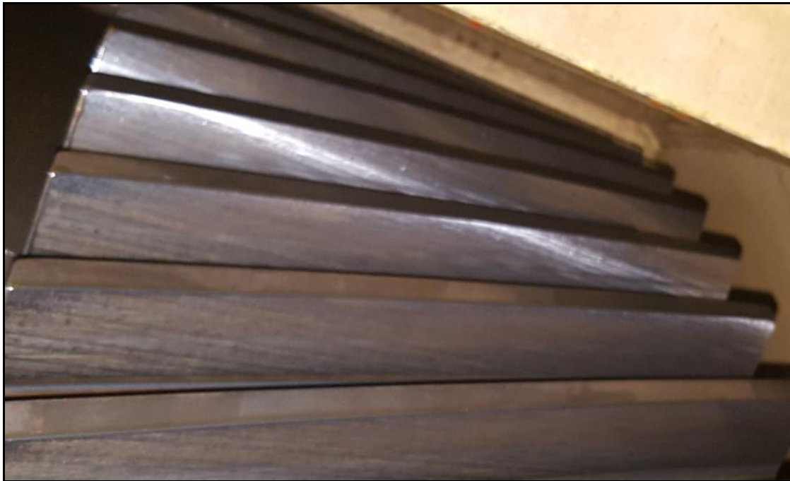
FIGURA 5.15- Foto da coroa da bobinadeira, sem evidências de pittings da hélice direita da coroa (27/10/2016).
