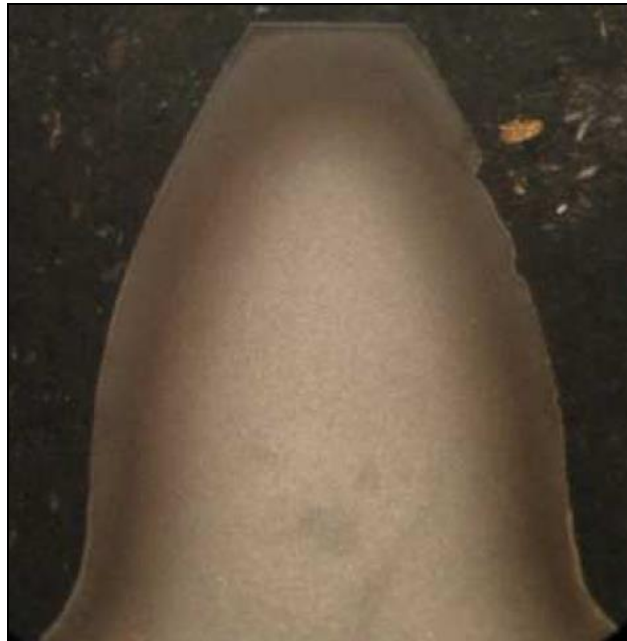
FIGURA 3.19- Macrografia da superfície cementada
