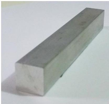
FIGURA 4.2 – Corpo de prova para ECAP
