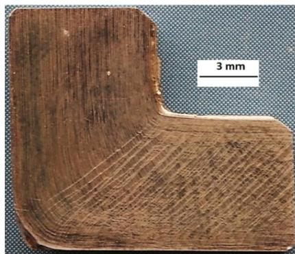
FIGURA 3.12 – Bandas de cisalhamento obtidas no processamento por ECAP.
