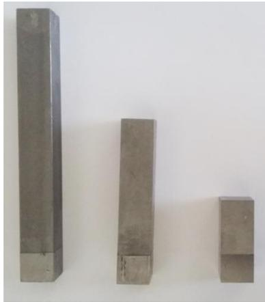
FIGURA 4.4 – Punções utilizados no processamento por ECAP
