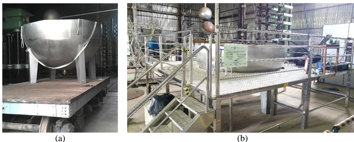
Fig. 3.1 – Cuba hemisférica de aço inox, 3 metros de diâmetro: (a) tanque hemisférico utilizado, (b) estrutura montada para as medições.
