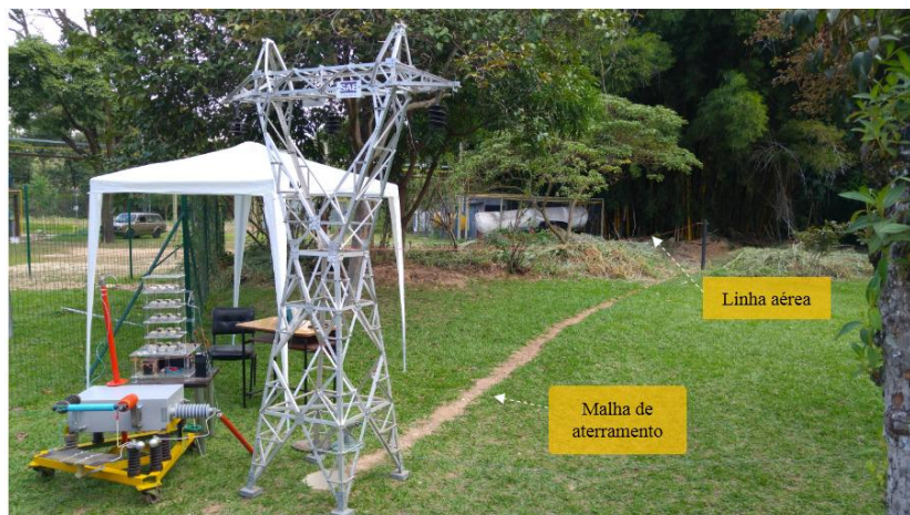
Fig. 5.8 – Fotografia do arranjo de testes montado no LEAT.
