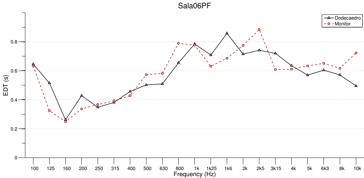
Figura 52 – Comparação entre o Tempo de Decaimento Inicial ( EDT ) medido com o Dodecaedro e o Monitor posicionados em F1 e o microfone em M1 para a Sala 06PF utilizando o VES.
