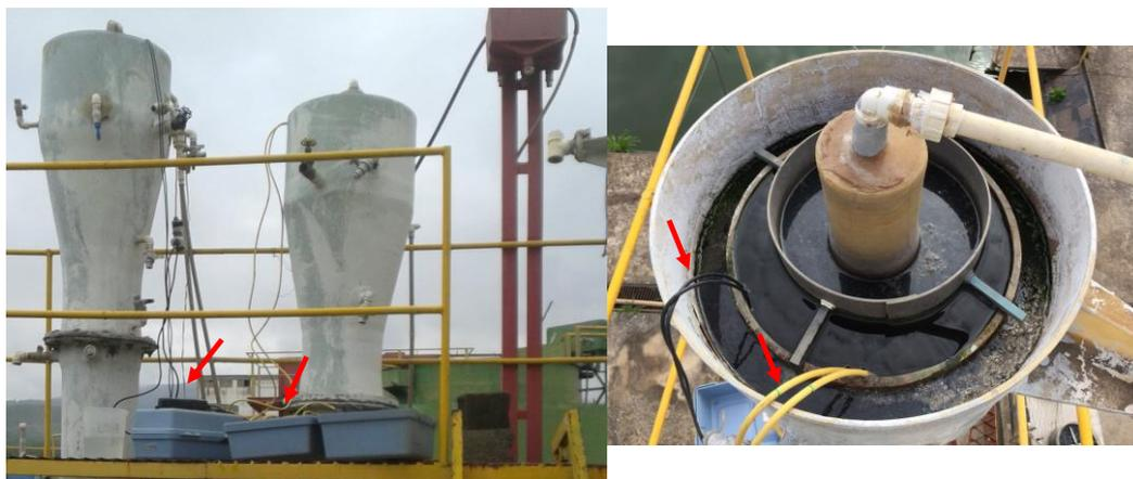
Os pontos de amostragem da fase líquida corresponderam ao afluente (esgoto bruto – E.B) e efluente dos reatores. Para fase gasosa, o ponto de amostragem refere-se à coleta do biogás de ambos os reatores. A Figura 4.1 exhibe os pontos amostrados durante o desenvolvimento desta pesquisa.
