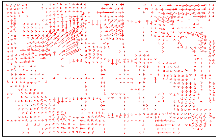
FIGURA 5.43. - Padrões de escoamento do modelo físico para vazão crescente de 3,4 L/s
