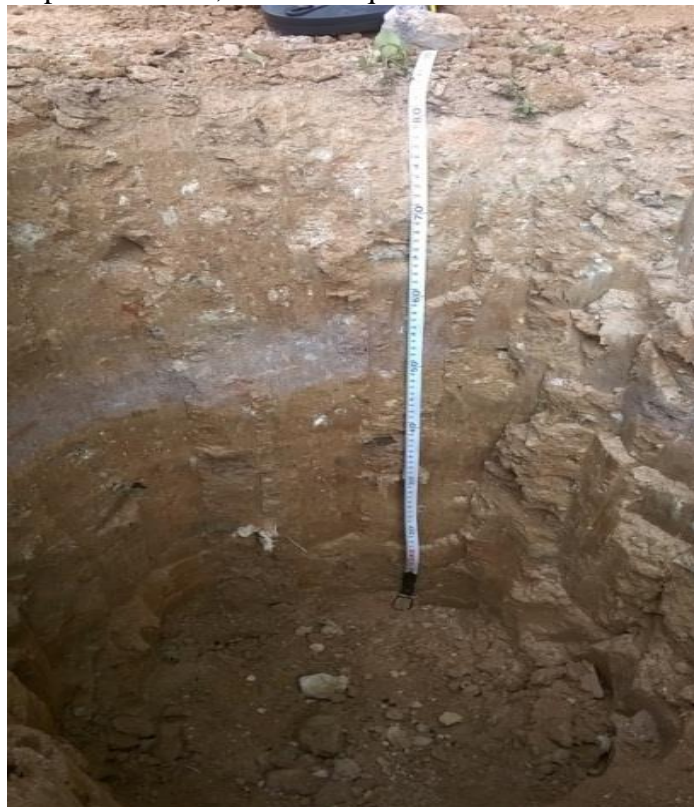
FIGURA 6 - Vista do perfil do solo, com destaque à ausência de horizontes após diagnóstico.
