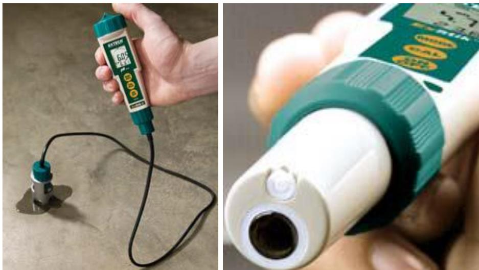
Figura 2.24 - pHmetro para medir pH em superfície de matriz cimentícia
