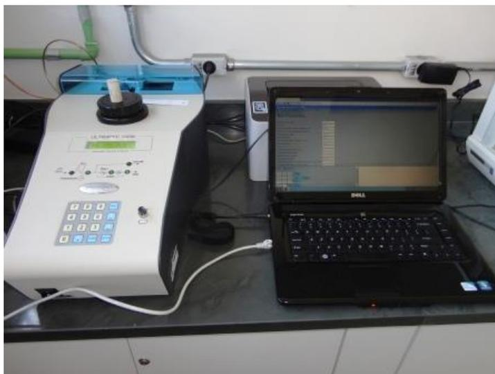
Figura 3.12 - Picnômetro de Hélio ULTRAPYC 1200e
