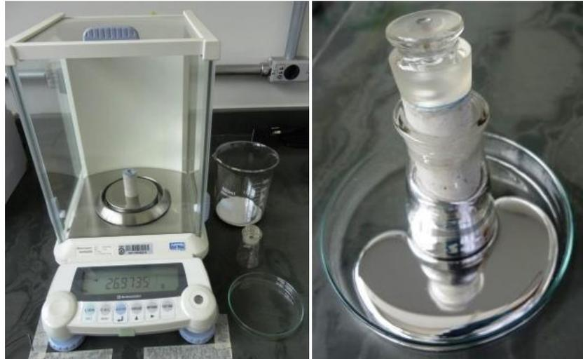
Figura 3.13 - Balança analítica e frasco para picnometria de mercúrio
