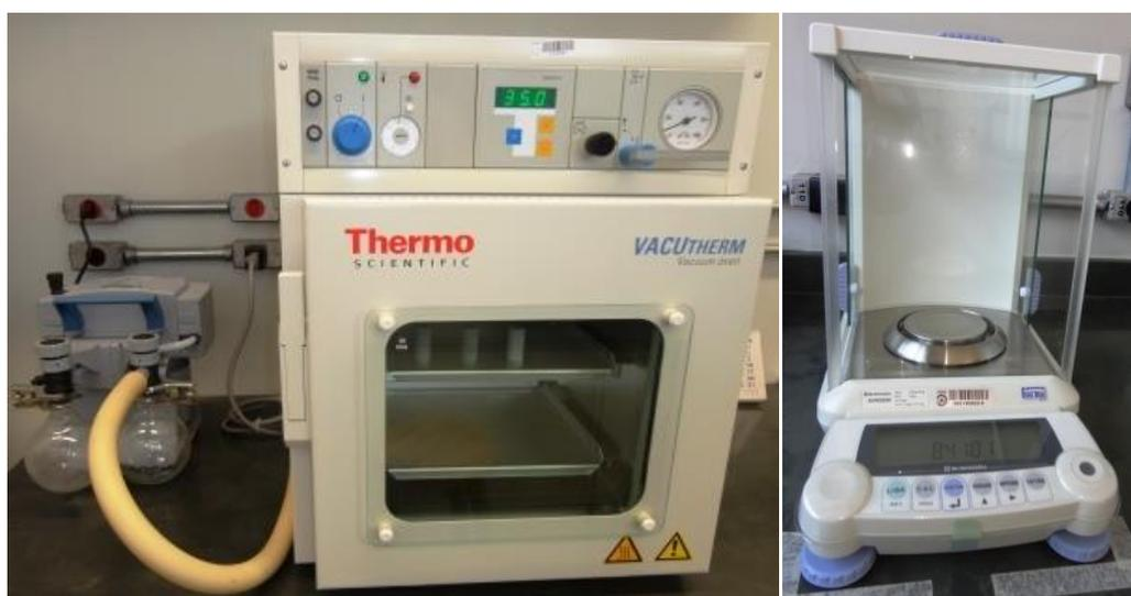
Figura 3.11 - Estufa de secagem e balança analítica
