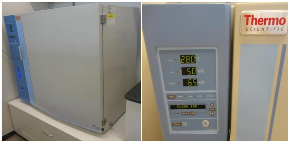
Figura 3.4 - Câmara de carbonatação acelerada
