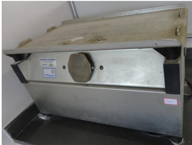
Figura 3.3 - Mesa vibratória utilizada no adensamento dos CPs (2 x 4) cm
