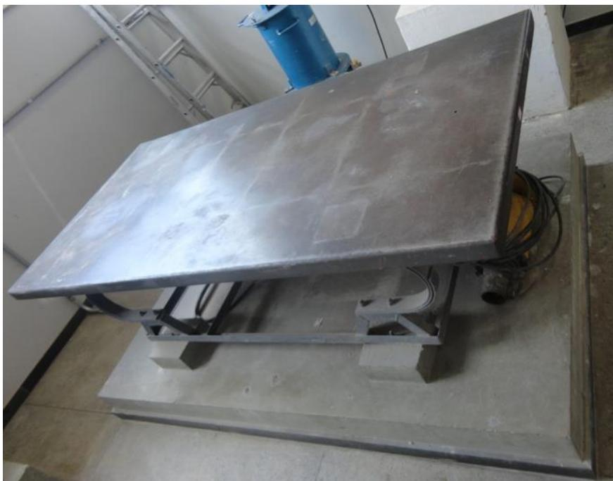
Figura 3.2 - Mesa vibratória utilizada no adensamento dos CPs (5 x 10) cm
