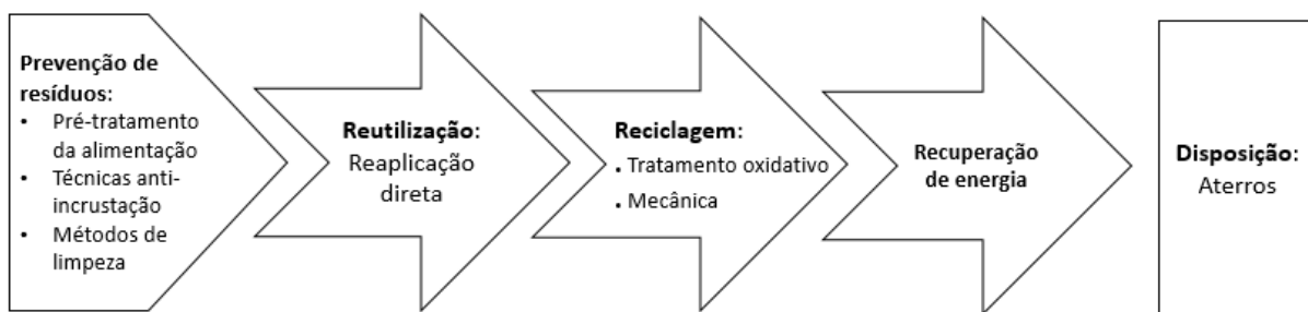
Figura 1.1.1 - Estratégias para membranas poliméricas que representam o espectro geral de tecnologias disponíveis para membranas de OI.
