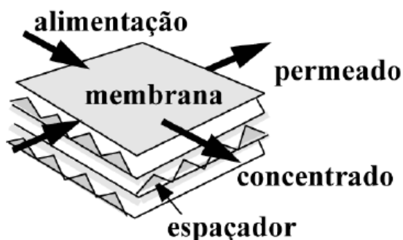
Figura 3.5.1.1 – Corte transversal de um módulo de membrana na configuração placa-e-quadro na posição horizontal.
