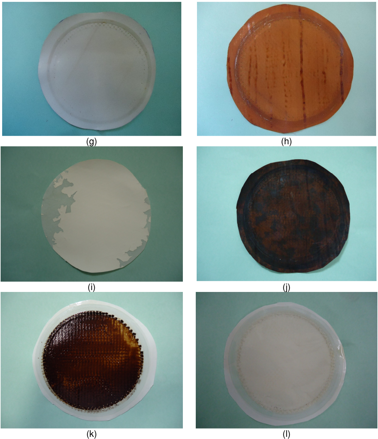
Figura 4.2.1 – Registros fotográficos das amostras de membranas: membrana nova (a), descartada “A” (b), após limpeza química (c), após reumedecimento com etanol-água (d), após tratamento com NaOH (e), após tratamento com NaClO (f), após tratamento com H 2 O 2 (g), após tratamento com KMnO 4 em pH neutro (h), após tratamento em elevada carga de NaClO em pH ácido (i), após tratamento com KMnO 4 em pH ácido (j), membrana oxidada com NaClO após incrustação acelerada de 30 h (k) e, após limpeza alcalina final (l).
