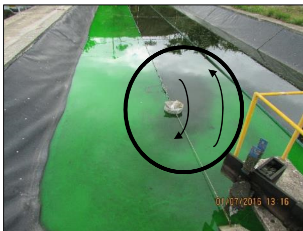
FIGURA 5.96: Registro fotográfico de corante fluorescente na curva da primeira chicana da lagoa 2, com destaque para a zona de estagnação visualizada junto à parede da chicana.
