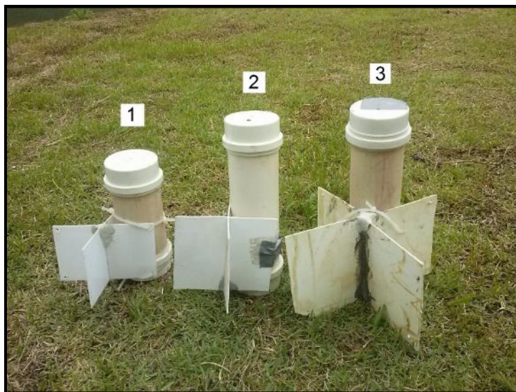
FIGURA 4.20: Registro fotográfico dos drogues verticais montados para análise de fluxo bidimensional nas lagoas do CePTS UFMG/COPASA.
