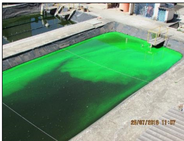
FIGURA 5.42: Registro fotográfico da aplicação do corante Uranina na entrada da lagoa 1, com destaque à zona de mistura no primeiro terço da lagoa - CePTS UFMG/COPASA
