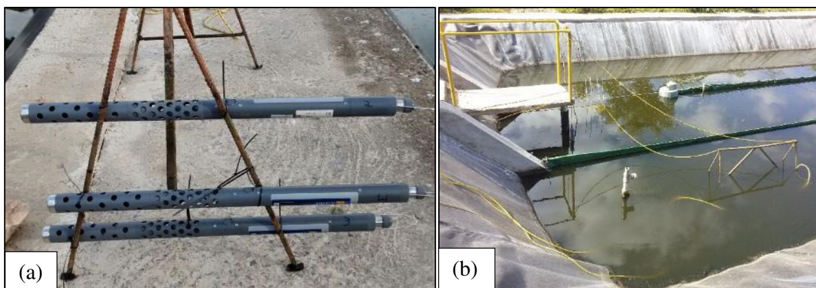
FIGURA 4.17: Registro fotográfico (a) da montagem das sondas YSI 600XLM V2® fixas em cavalete e (b) das sondas Global Water WQ101® na entrada da lagoa 2 – CePTS UFMG/COPASA.
