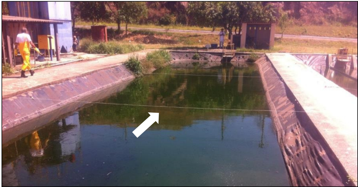
FIGURA 4.25: Registro fotográfico da lagoa 1 com os transectos marcados com barbante para identificação das seções de medição - CePTS UFMG/COPASA
