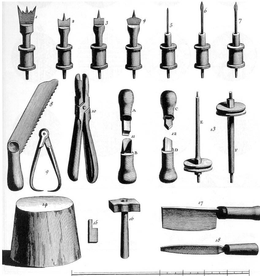
Figura 3 – Ferramentas usadas na produção de moldes de botões. "Button Maker." The Encyclopedia of Diderot & d'Alembert Collaborative Translation Project . Ann Arbor: Michigan Publishing, 2010. Originalmente publicado em "Boutonnier", Encyclopédie ou Dictionnaire raisonné des sciences, des arts et des métiers , vol. 2, Paris, 1763.
