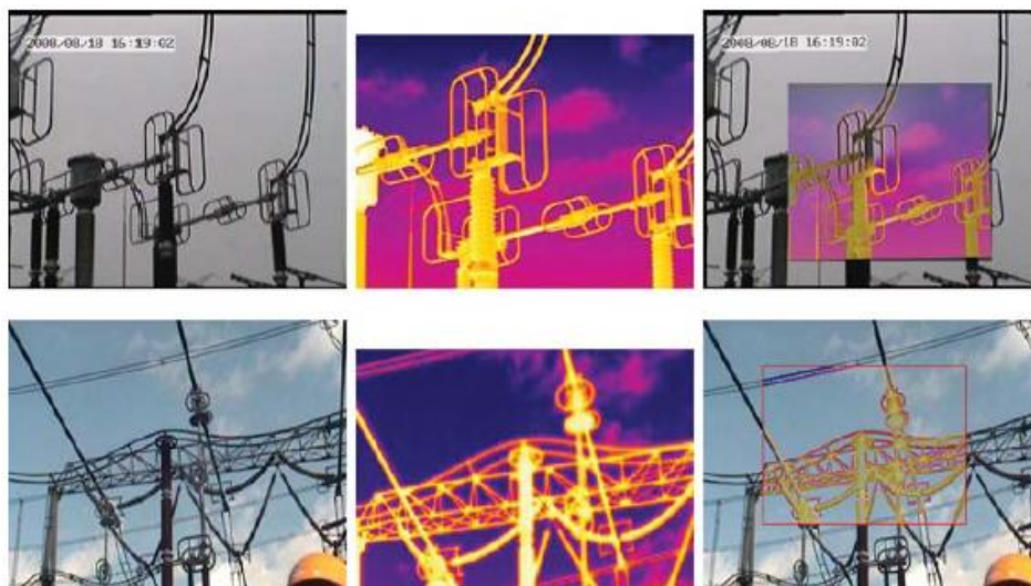
Figura 5.16 – Imagens registradas e analisadas pelas câmeras do SmartGuard. Fonte: (WANG, GUO, et al. , 2011).
