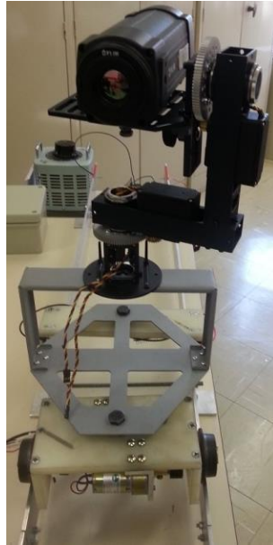
Figura 6.12 – Conjunto de movimentação, chassi e Pan/Tilt montados. Fonte: Arquivos LabTerm.
