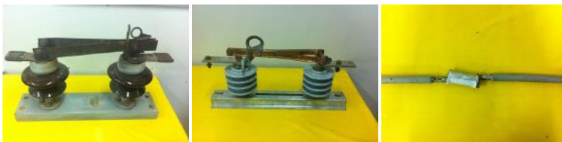
Figura 7.4 – Equipamentos utilizados nos ensaios de corrente. À esquerda, chave seccionadora antiga. Ao centro, chave seccionadora nova. À direita, conexão H. Adaptado de (SILVA, 2015).
