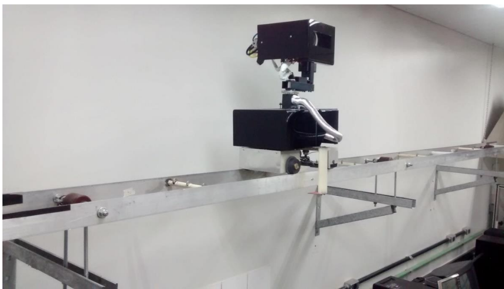
Figura 6.18 – Versão final do Sistema Autônomo de Inspeção construído e instalado no Laboratório de Termometria da UFMG, onde foram realizados os testes de validação. Fonte: Arquivo LabTerm.
