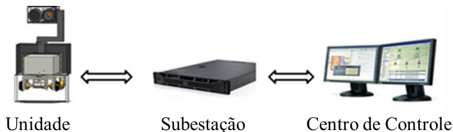
Figura 6.14 – A unidade de inspeção se comunica com a subestação, e esta permite ao centro de controle acessar todo o sistema, através da internet ou da rede interna. Fonte: Arquivos LabTerm.
