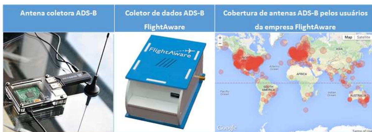
Figura 2.2: Coletores ADS-B e uma rede de cobertura [FlightAware, 2017a]
