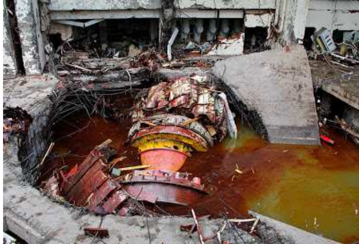
FIGURA 27 – Hidrogerador após o acidente FONTE: MAESTRI, 2016
