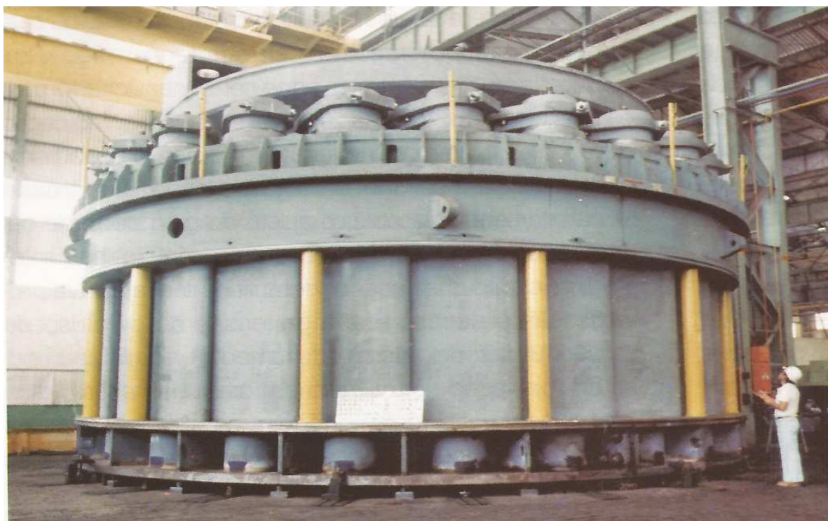
FIGURA 10 – Distribuidor FONTE: ITAIPU, 2009, P. 12.32
