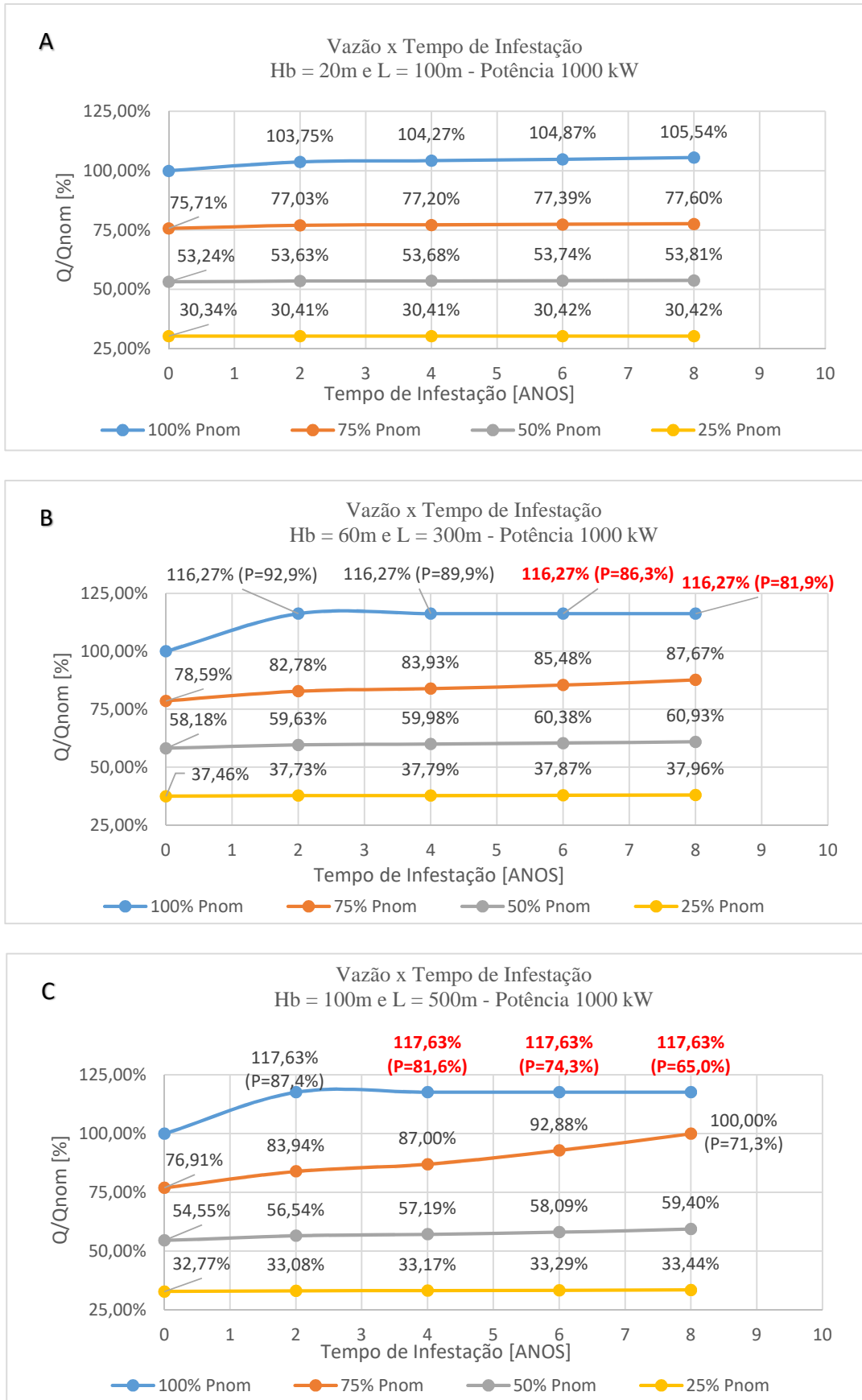
FIGURA 36 – Vazão em função do tempo de infestação do mexilhão-dourado para as três configurações de CGH na potência de 1.000 kW. FONTE: PRÓPRIO AUTOR
