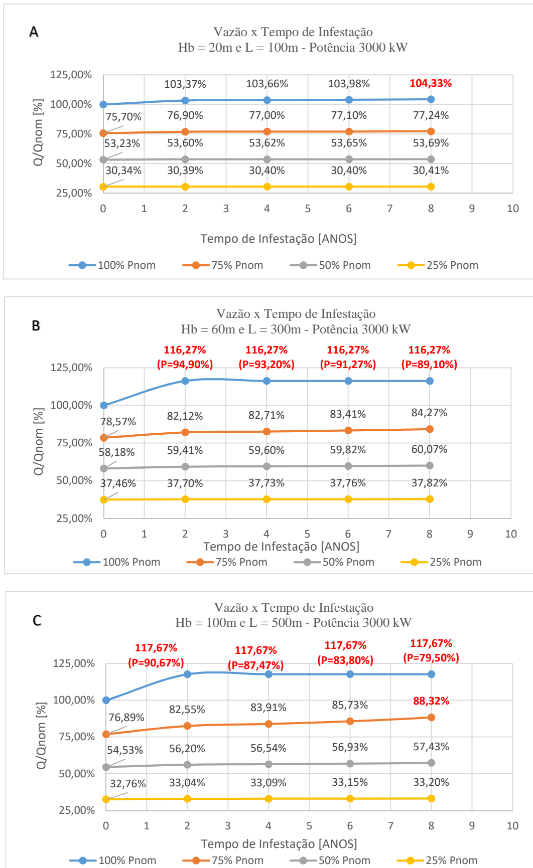
FIGURA 38 - Vazão em função do tempo de infestação do mexilhão-dourado para as três configurações de CGH na potência de 3.000 kW.
