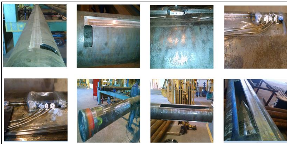
Figura 31 - Fotos corpo de prova (Montagem e instrumentação)
