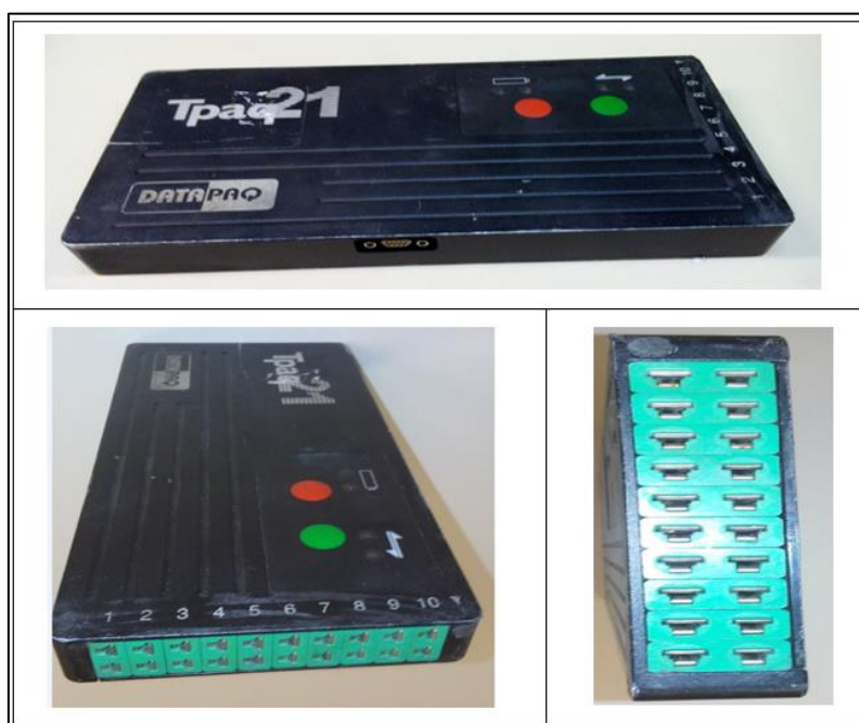
Figura 28 - Unidade de tratamento de sinal (Tpaq21)
