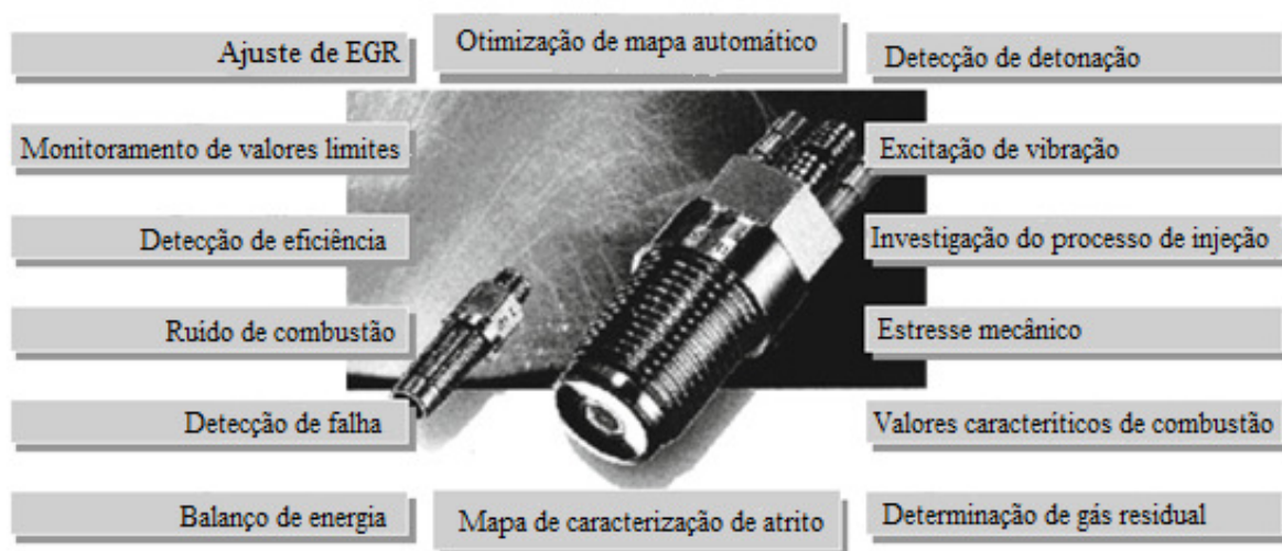
Figura 3.20 – Áreas de aplicação da tecnologia de medição de pressão.
