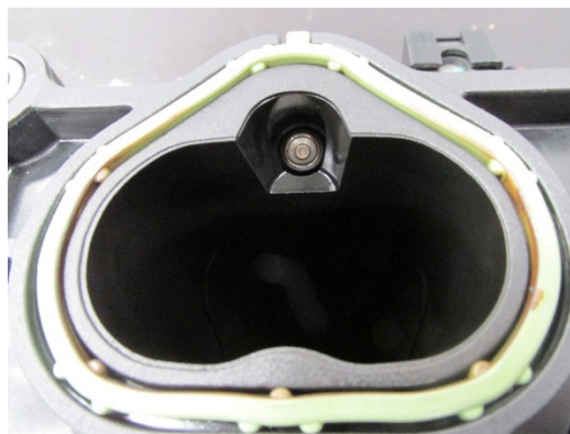
Figura 3.02 – Imagem do posicionamento do injetor no coletor de aspiração.
