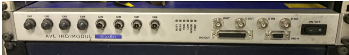
Figura 3.22 – Imagem mostrando o analisador de combustão ( Indimodul ) que foi utilizado nos teste.
