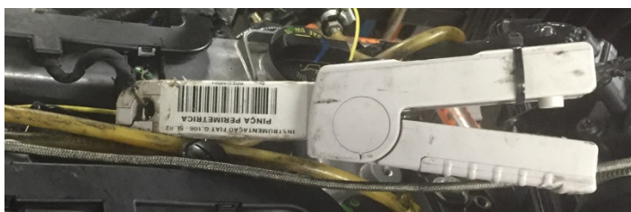
Figura 3.28 – Ponta de prova de corrente montada no motor.
