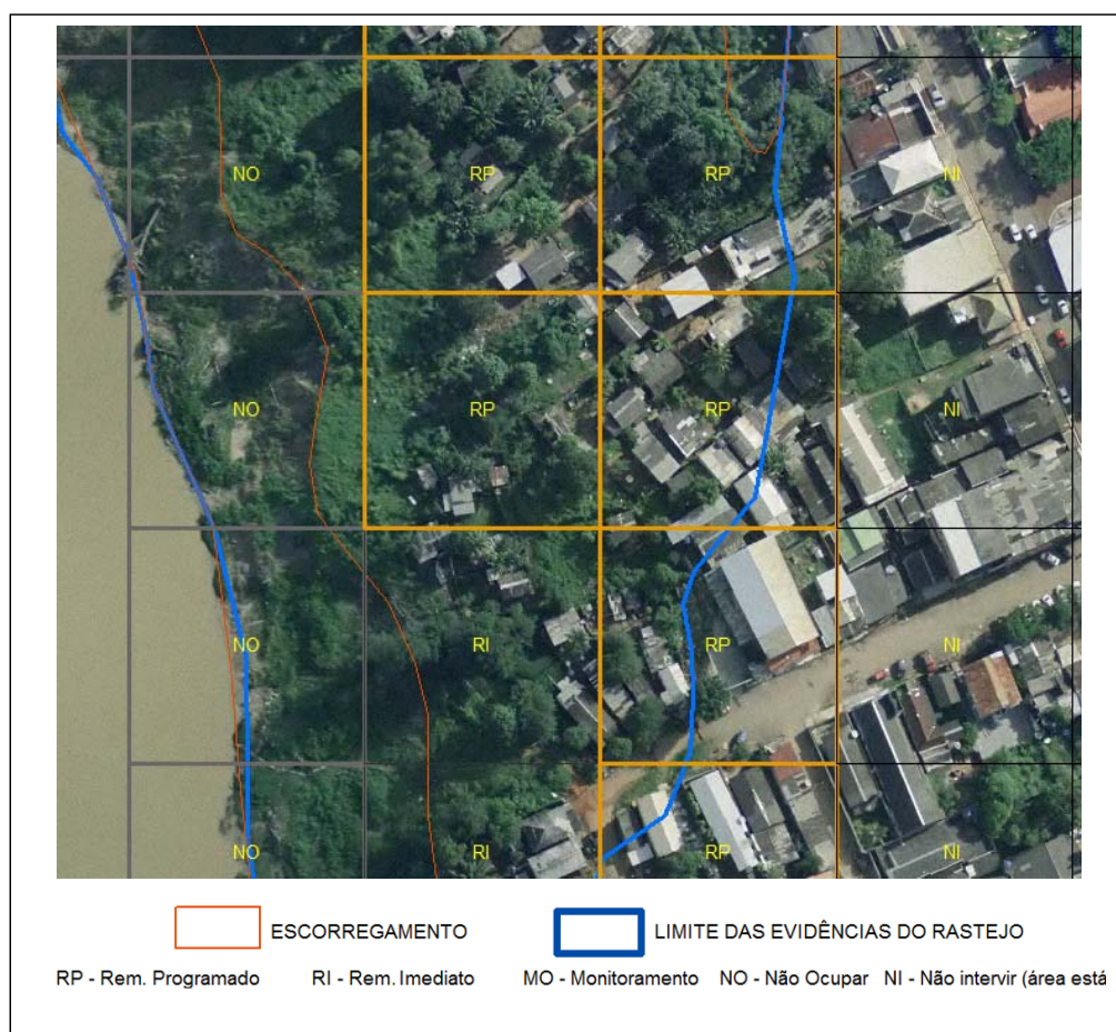
Figura 4.17 - Comparação entre as ações mitigadoras e o cadastro de sinais de instabilidade.
