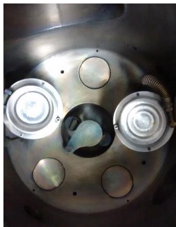
Figura 14: Interior da câmara de vácuo do Orion 5-HV Sputtering Systems .
