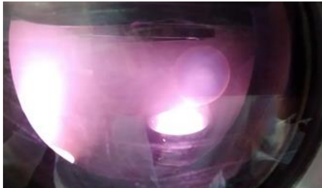
Figura 2: Plasma formado no interior da câmara de sputtering.
