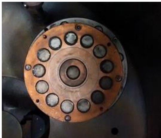
Figura 3: Conformação dos ímãs magnéticos na câmara de sputtering.
