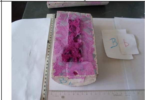
Ensaio de Carbonatação Amostra B b
