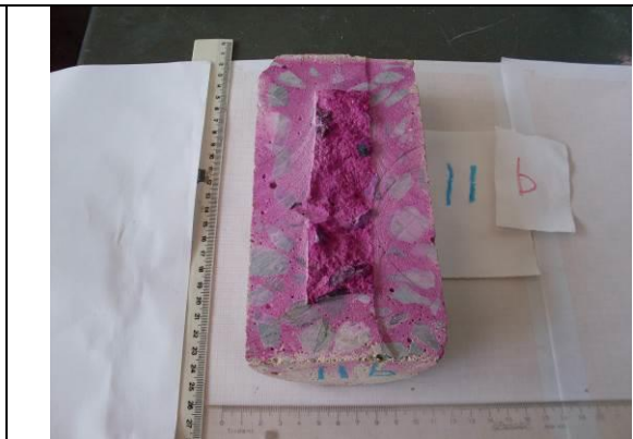
Ensaio de Carbonatação Amostra 11 b
