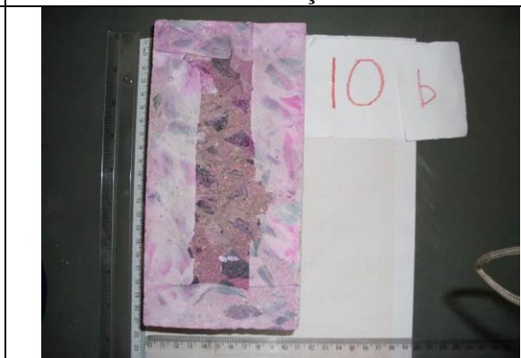
Ensaio de Carbonatação Amostra 10 b
