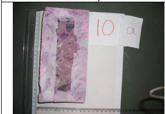
Ensaio de Carbonatação Amostra 10 a
