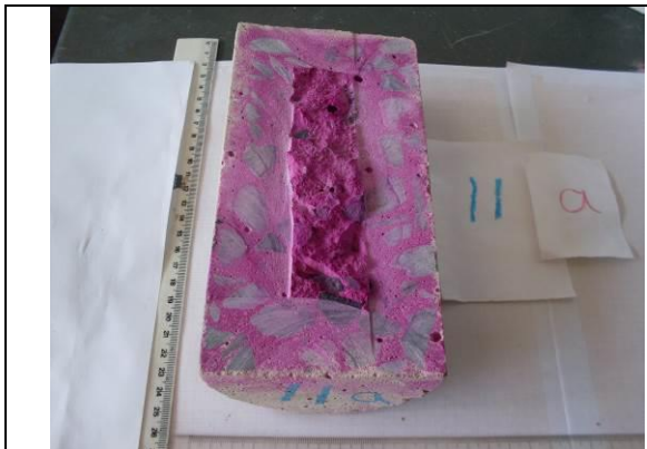
Ensaio de Carbonatação Amostra 11 a
