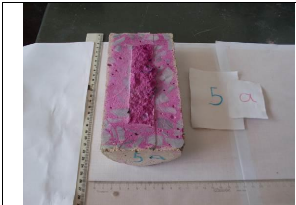
Ensaio de Carbonatação Amostra 5 a
