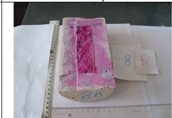
Ensaio de Carbonatação Amostra 8 b
