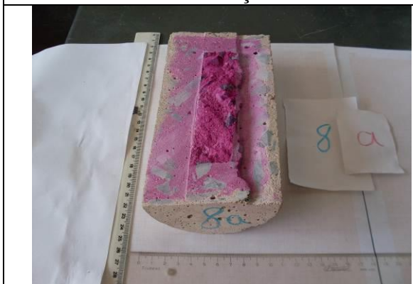
Ensaio de Carbonatação Amostra 8 a
