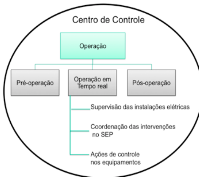
Figura 12 – Atividades da operação nos centros de controle
