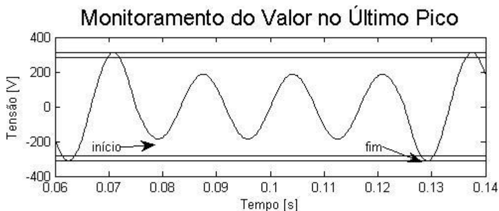
Figura 2.6: Exemplo de afundamento de tensão e indicações de início e fim da detecção pelo método de monitoramento do valor no último pico.
