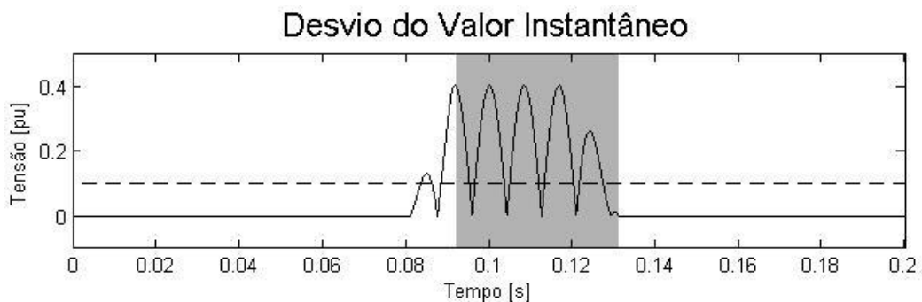
Figura 3.27: Desvio do valor instantâneo de tensão de rede em relação a tensão de referência durante a simulação da técnica de monitoramento dessa variável com dados gerados de tensão senoidal com afundamento de tensão.
