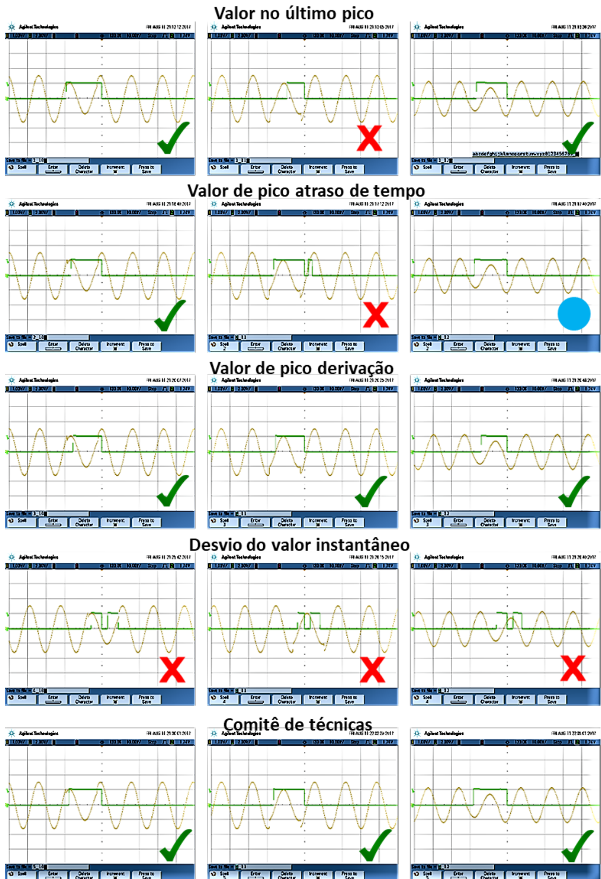
Figura 4.16: Resultados experimentais com protótipo de detector de afundamento de tensão executando cada técnica em cada fase submetida ao quarto regime transitório programado.
