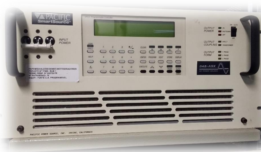
Figura 4.4: Dispositivo – fonte de tensão programada – 345ASX da Pacific Power Source usado nos testes de detecção de afundamento de tensão em ambiente real com protótipo de detector.
