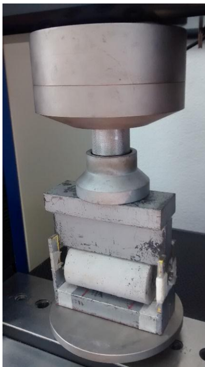
Figura 3.10 – Aparato para compressão diametral
