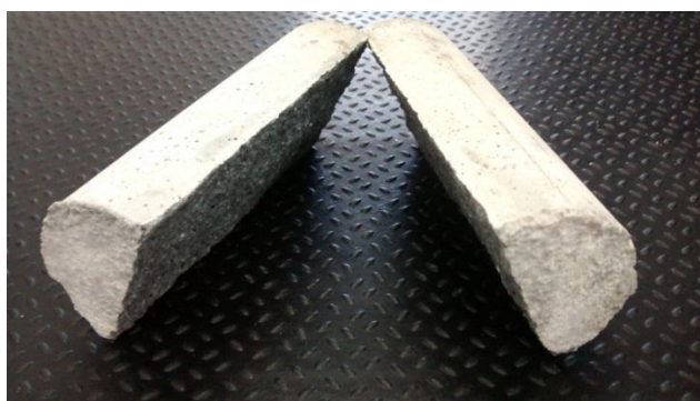
Figura 3.11 – Corpo de prova rompido
