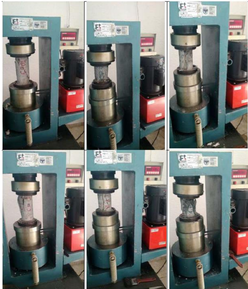
Figura 4.8 – Detalhes do ensaio de compressão e monitoramento da ruptura do corpo de prova cilíndrico
