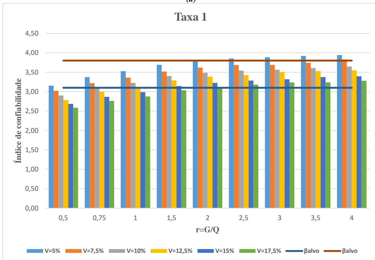
Figura 7.17 – Níveis de confiabilidade: Pilar P8, combinação V_I K_I
