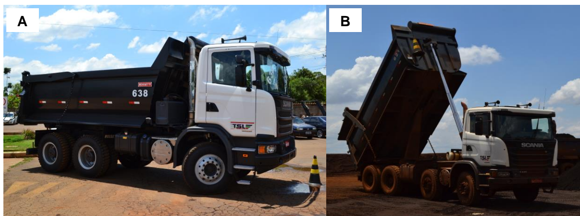
FIGURA 36 - Posição da caçamba abaixada (A) e em máxima báscula (B)
