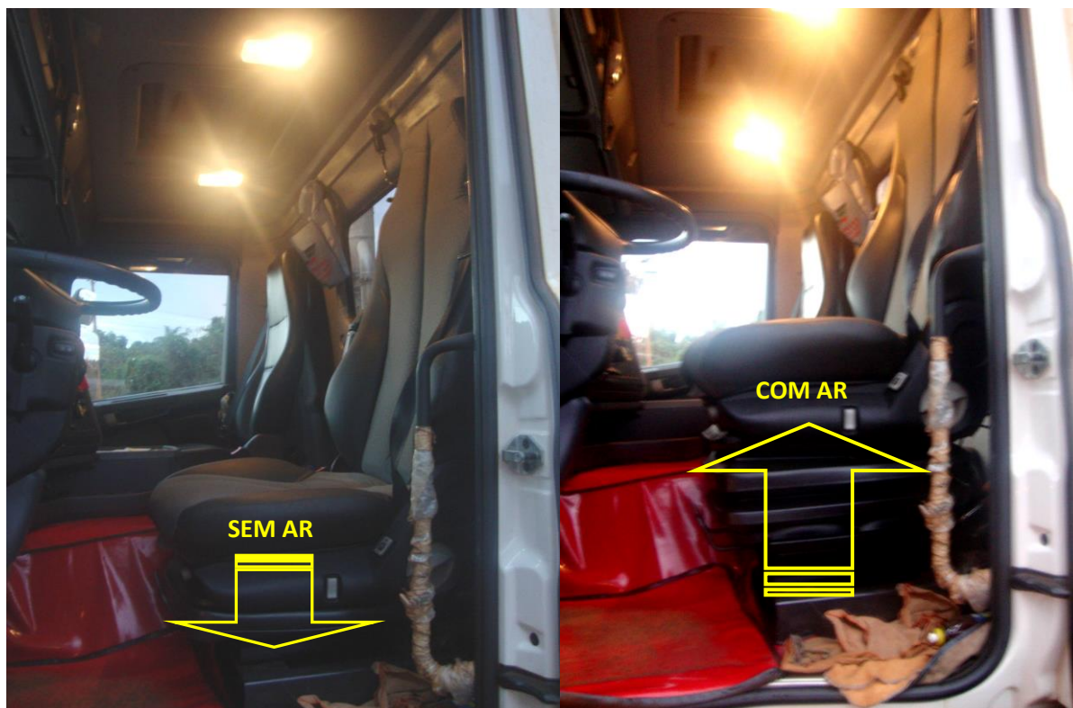
FIGURA 34 - Sistema independente de suspensão a ar do assento
