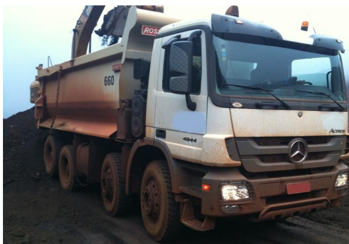
FIGURA 29 - Caminhão Mercedes-Benz Actros fora de estrada 8x4 (Fonte: do próprio autor, 2014)
