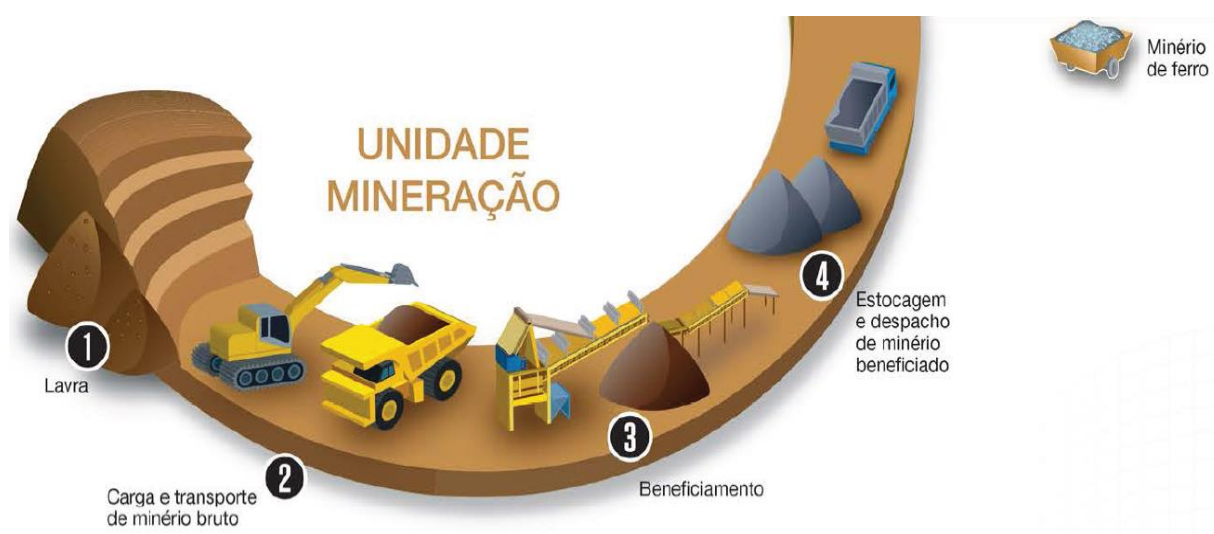
FIGURA 9 - Processo produtivo do minério de ferro
