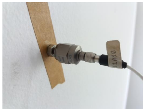
Figura 5.13: Acelerômetro anexado à parede
