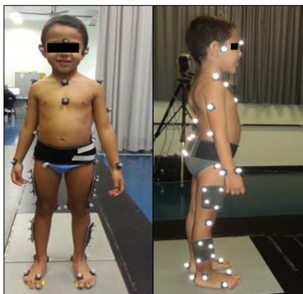
FIGURA 4- Disposição dos marcadores refletivos nas visões anterior e lateral direita.
