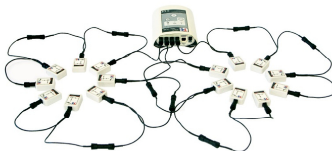
Figura 8. Tech MCS - concentrador Tech HUB e Unidades de medição inercial
