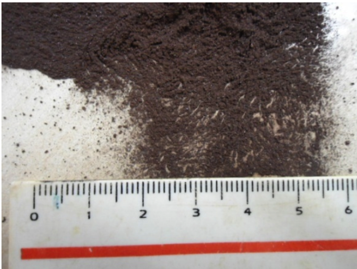
Figura 44 – Visual dos sólidos secos de minério de ferro da polpa do sistema
