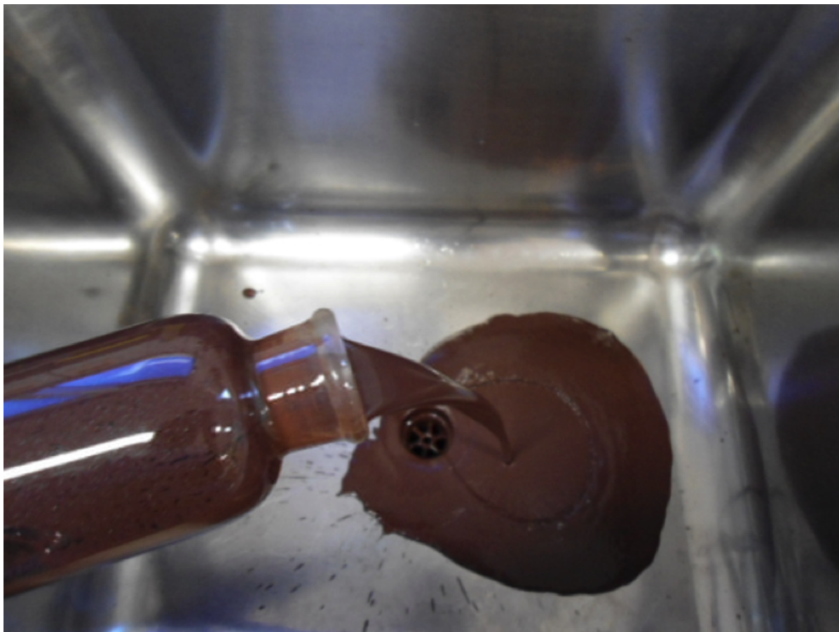
Figura 45 – Aspecto visual da polpa transportada no mineroduto na sua concentração de operação
