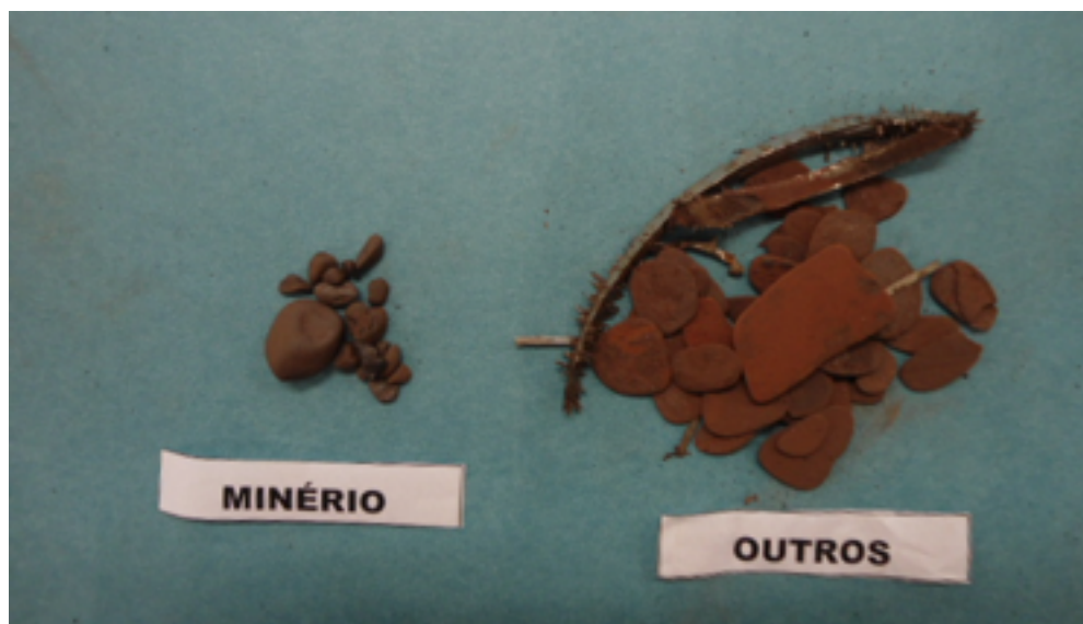
Figura 57 – Amostra de materiais depositados no mineroduto
