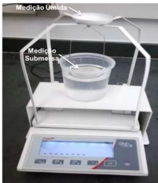
Figura 5.17 - Aparato para determinação da porosidade total, porosidade aberta e densidade volumétrica das amostras de pasta de cimento e de RPC usando o princípio de Arquimedes
