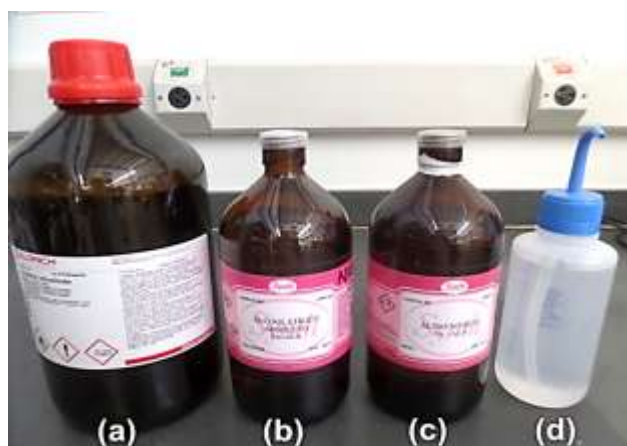
Figura 5.5 - Reagentes utilizados na preparação das sílicas sol-gel: (a) TEOS; (b) etanol; (c) ácido nítrico; (d) água deionizada
