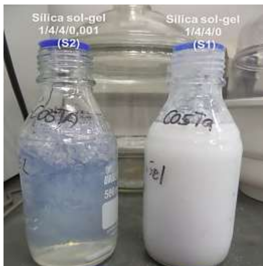
Figura 5.7 - Sílica sol-gel S1 e S2 após 24 horas na estufa a 90 °C
