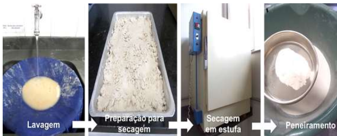
Figura 5.3 - Preparação da areia utilizada
