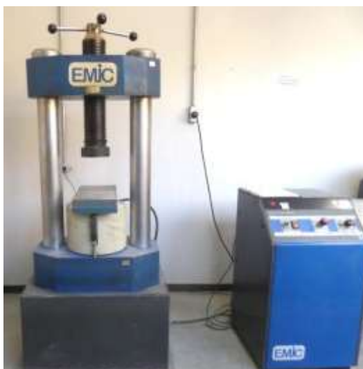
Figura 5.19 - Prensa hidráulica utilizada para realização do ensaio de resistência à compressão
