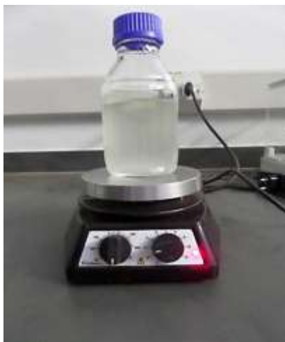
Figura 5.6 - Etapa de agitação magnética para preparação da sílica sol-gel
