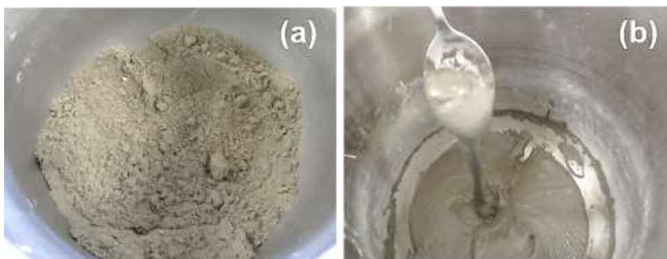
Figura 5.10 - Aspecto da mistura de um dos lotes de amostras de RPC produzido: (a) aspecto da mistura após a adição de água; (b) aspecto final da mistura
