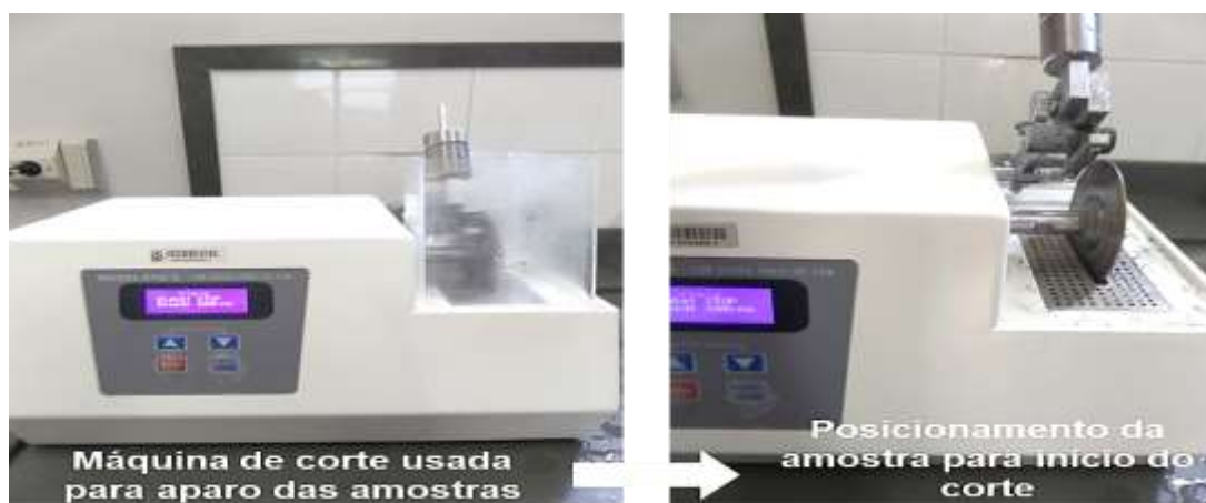
Figura 5.15 - Processo de aparo das amostras para regularização da superfície
