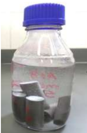
Figura 5.14 - Amostras de RPC submetidas a cura submersa em água a temperatura ambiente
