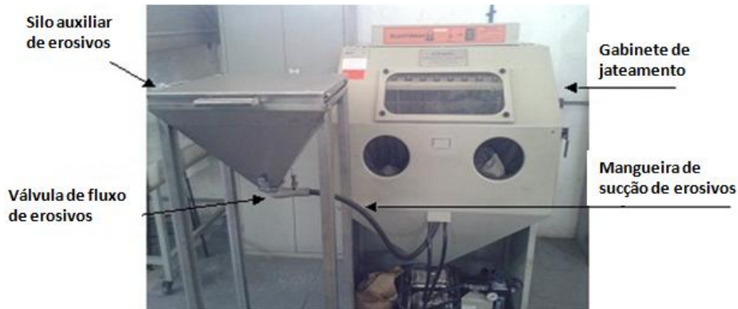
Figura 5.3 – Silo externo adaptado à cabine de jateamento para ensaios de desgaste erosivo.
