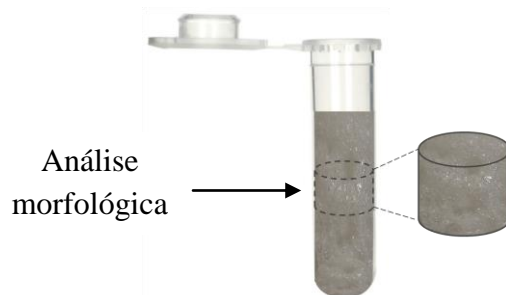
Figura 4.4: Ilustração da porção de material caracterizada morfolologicamente após a liofilização.
