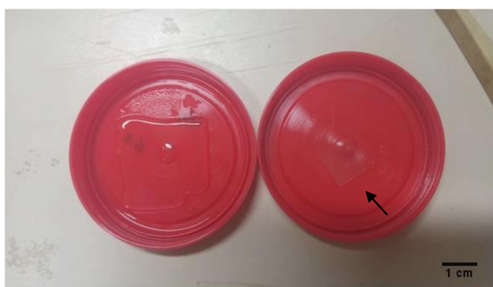
Figura 5.40: Filme de quitosana e gelatina não reticuladas antes e após o intumescimento em PBS, a 37^\circ\text{C} , por 1h.
