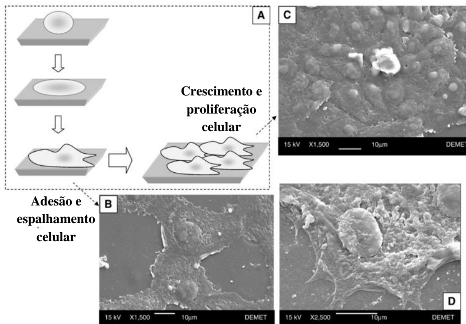
Figura 3.18: Aderência e espalhamento de células VERO semeadas em matrizes de quitosana e PVA para o ensaio de biocompatibilidade. (A) Desenhos animados do processo de interação celular: adesão, propagação, proliferação; (B), (C) e (D): imagens de MEV que ilustram a morfologia típica de células semeadas em blends de quitosana, PVA e glutaraldeído.
