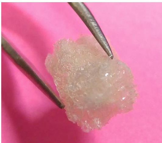
Figura 5.25: Seção longitudinal de matriz de blenda de quitosana e gelatina.
