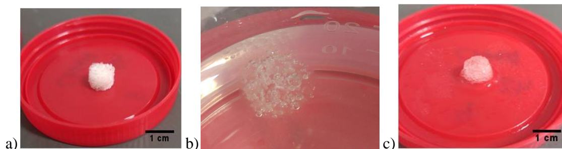
Figura 5.50: Matriz de ChMA pronta para o ensaio de intumescimento, a); A mesma matriz imersa na solução de PBS, a 37\pm 1^\circ\text{C} , em b); e no seu estado intumescido após a retirada da solução de imersão, em c).
