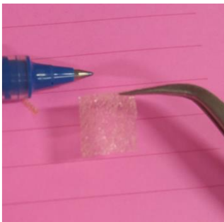
Figura 5.42: Filme fotorreticulado de ChMA destinado ao ensaio de intumescimento em PBS, a 37\pm 1^\circ\text{C} .
