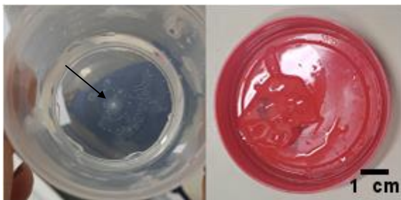
Figura 5.41: Perda da coesão de filme de quitosana e gelatina não reticuladas após tentativa de manipulação do material para pesagem.
