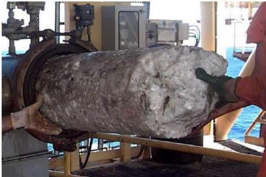
Figura 3.7 - Bloqueio de linha por hidrato em Unidade de Produção.
